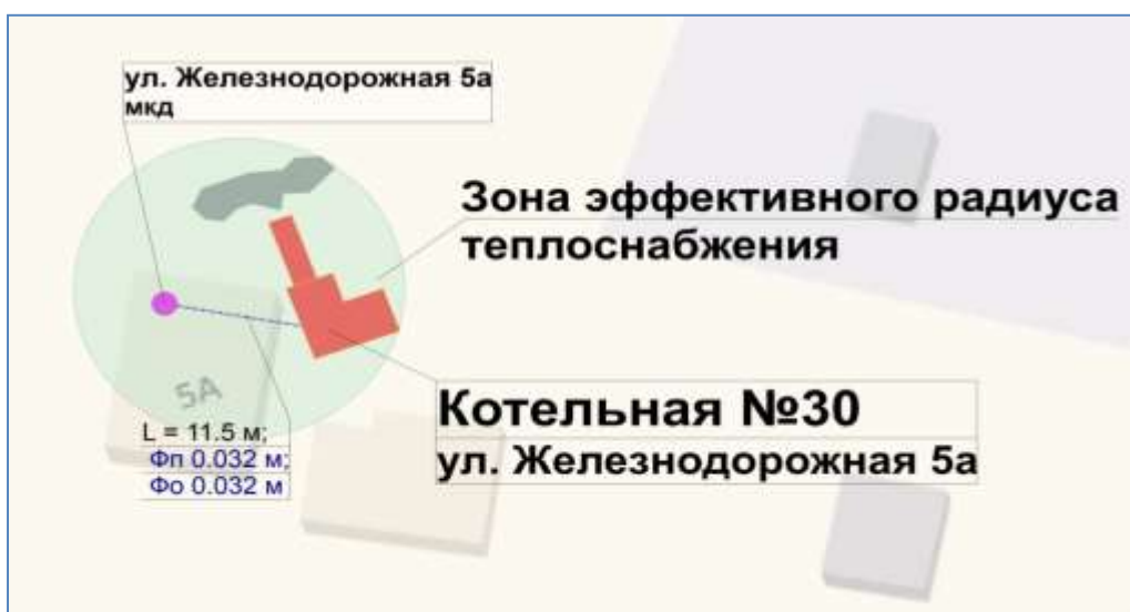
Рисунок 29. Зона эффективного радиуса теплоснабжения котельной № 30
