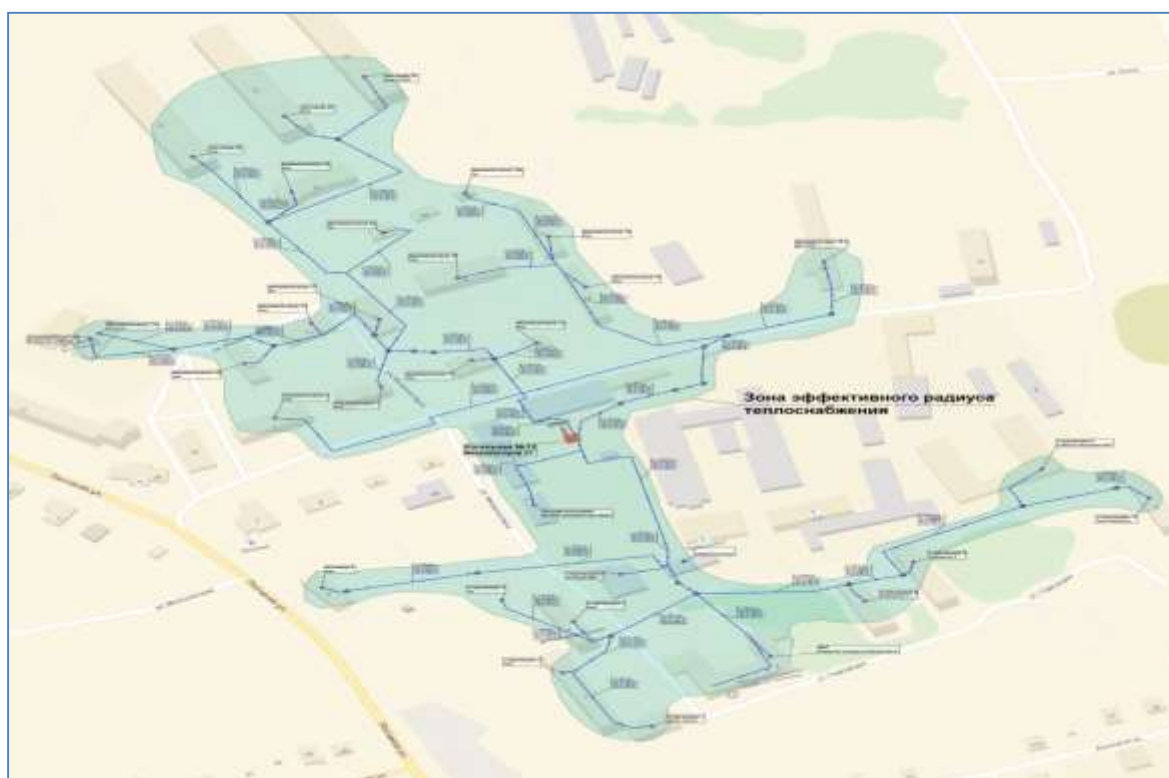
Рисунок 24. Зона эффективного радиуса теплоснабжения котельной № 12
