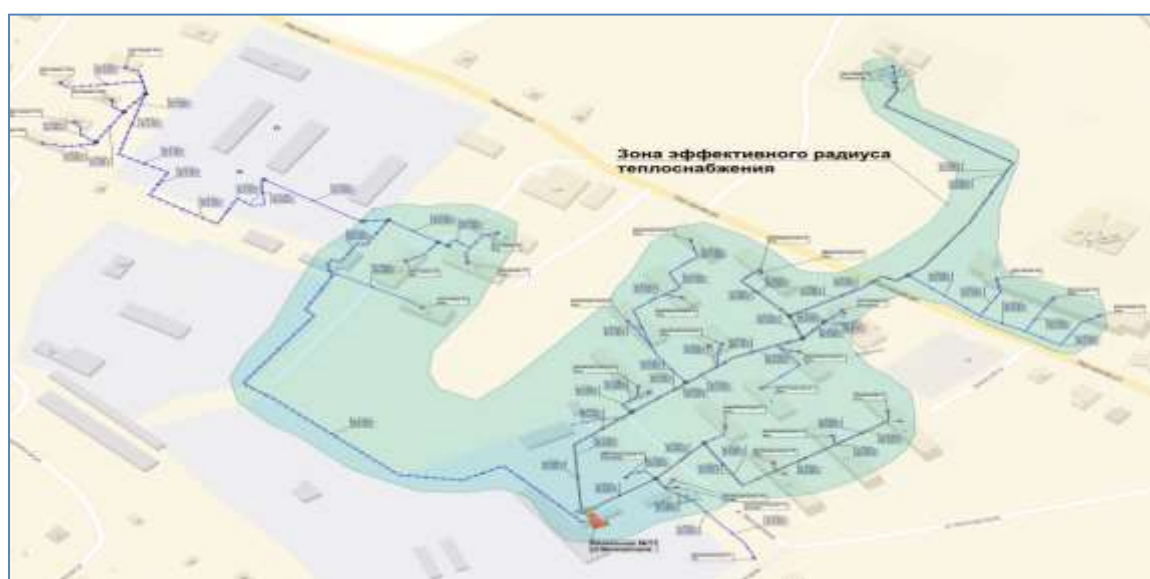
Рисунок 23. Зона эффективного радиуса теплоснабжения котельной № 11
