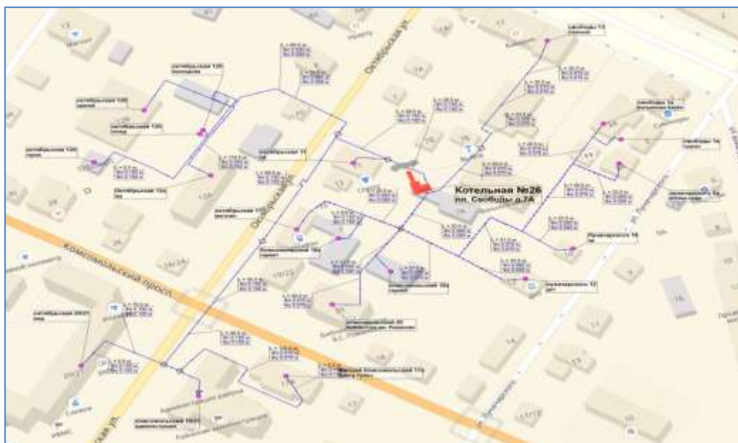
Рисунок 10. Схема тепловых сетей котельной № 26
