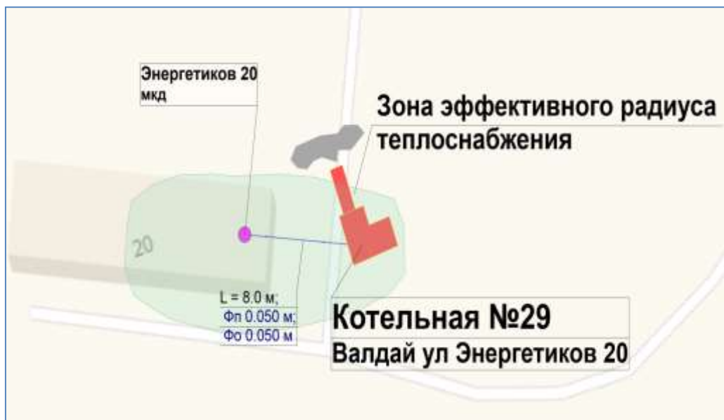
Рисунок 28. Зона эффективного радиуса теплоснабжения котельной № 29
