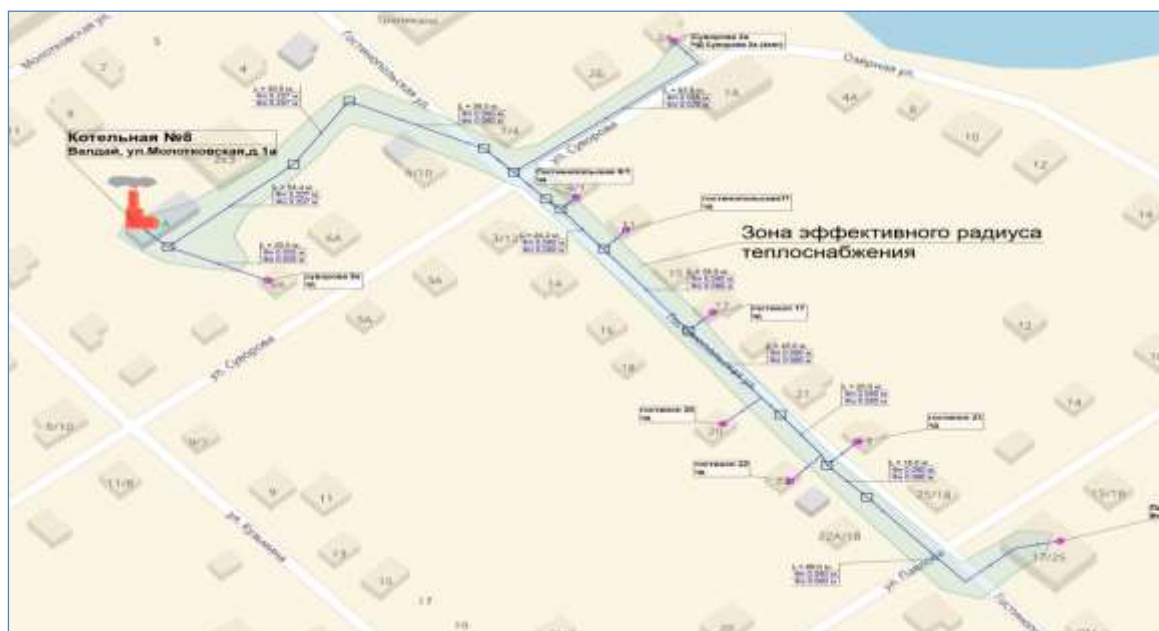
Рисунок 21. Зона эффективного радиуса теплоснабжения котельной № 8
