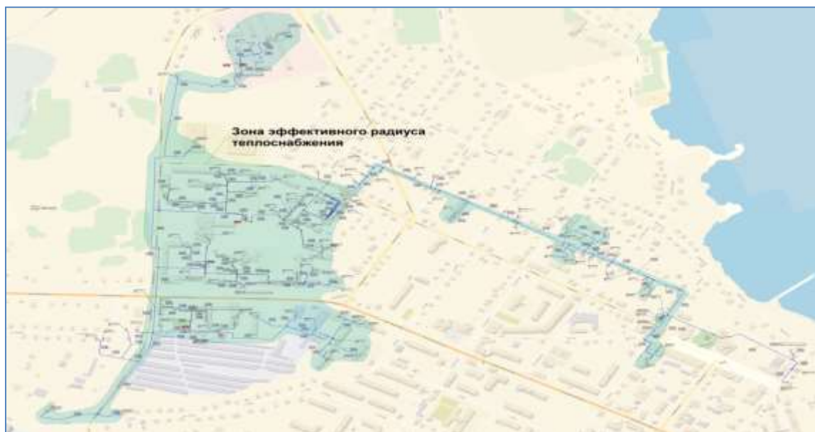
Рисунок 22. Зона эффективного радиуса теплоснабжения БМК 21 МВт
