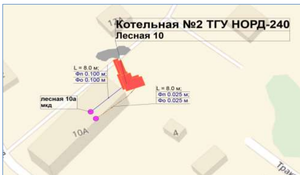
Рисунок 2. Схема тепловых сетей ТГУ Норд -240
