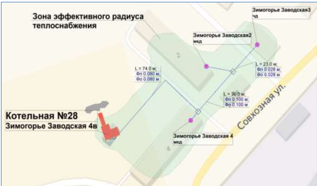
Рисунок 27. Зона эффективного радиуса теплоснабжения котельной № 28
