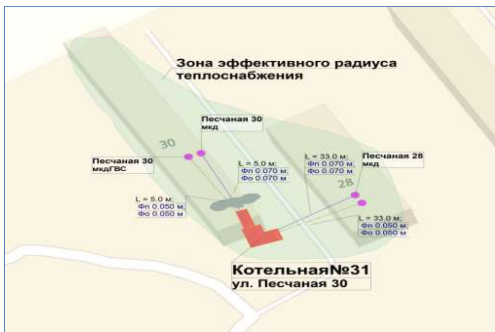
Рисунок 30. Зона эффективного радиуса теплоснабжения котельной № 31
