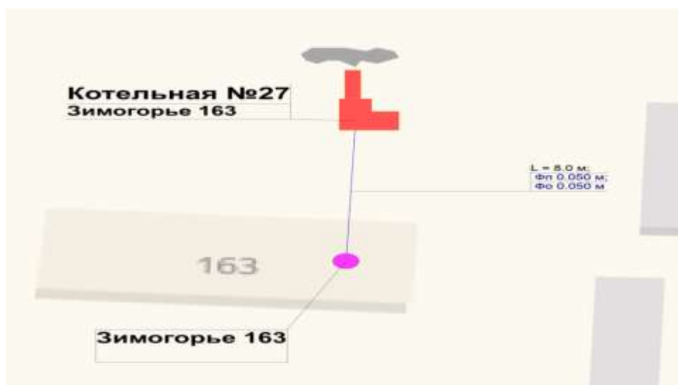
Рисунок 11. Схема тепловых сетей котельной № 27 Валдайский р-н, с. Зимогорье, д. 163
