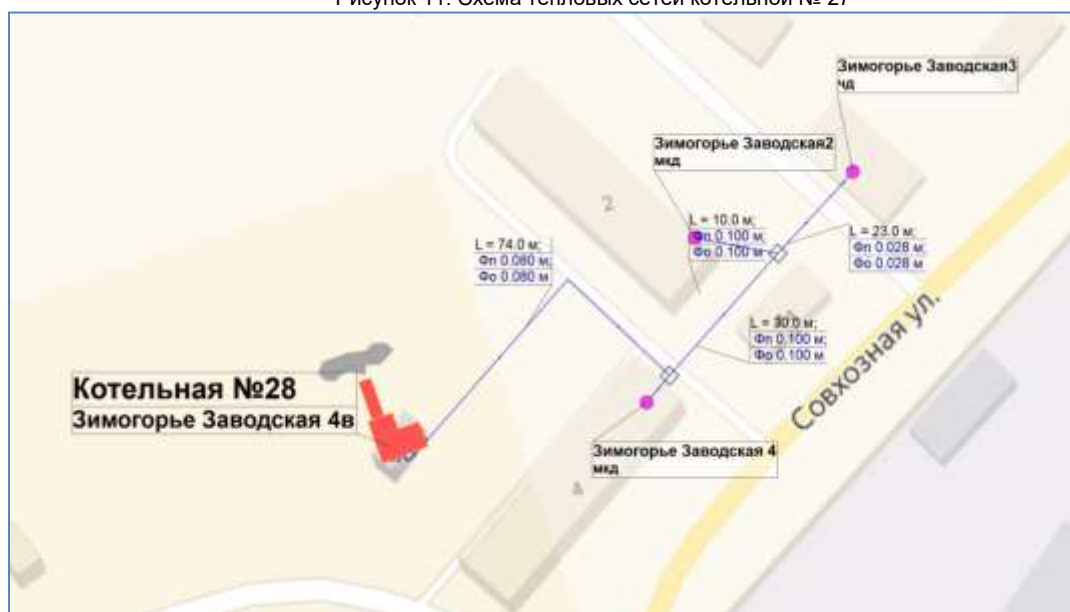
Рисунок 12. Схема тепловых сетей котельной № 28
