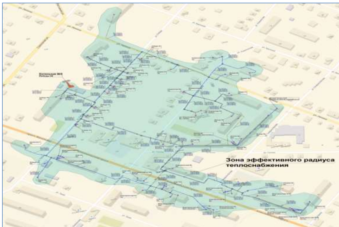
Рисунок 19. Зона эффективного радиуса теплоснабжения котельной № 5
