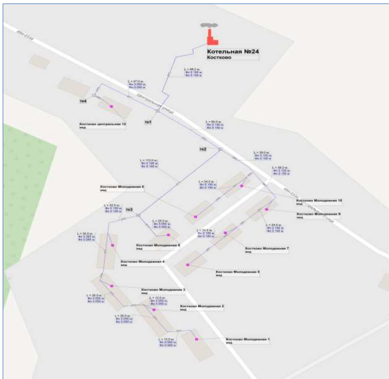
Рисунок 1. Схема тепловых сетей котельной № 24, д. Костково
