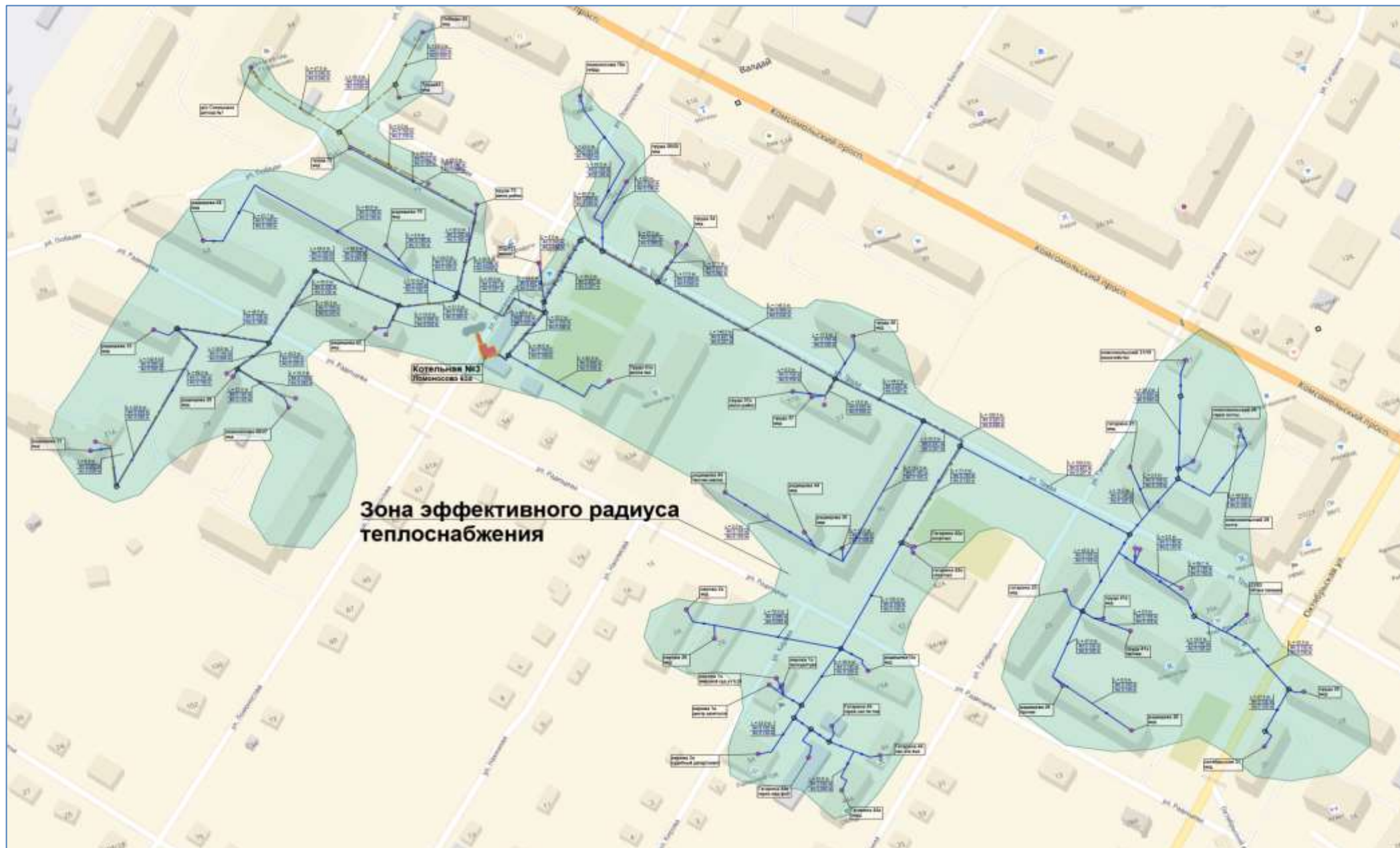
Рисунок 18. Зона эффективного радиуса теплоснабжения котельной № 3
