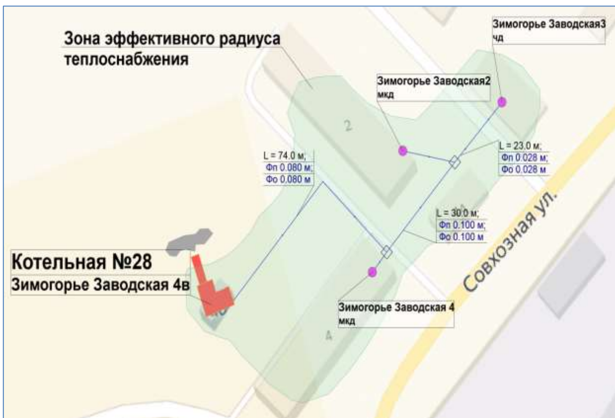
Рисунок 27. Зона эффективного радиуса теплоснабжения котельной № 28
