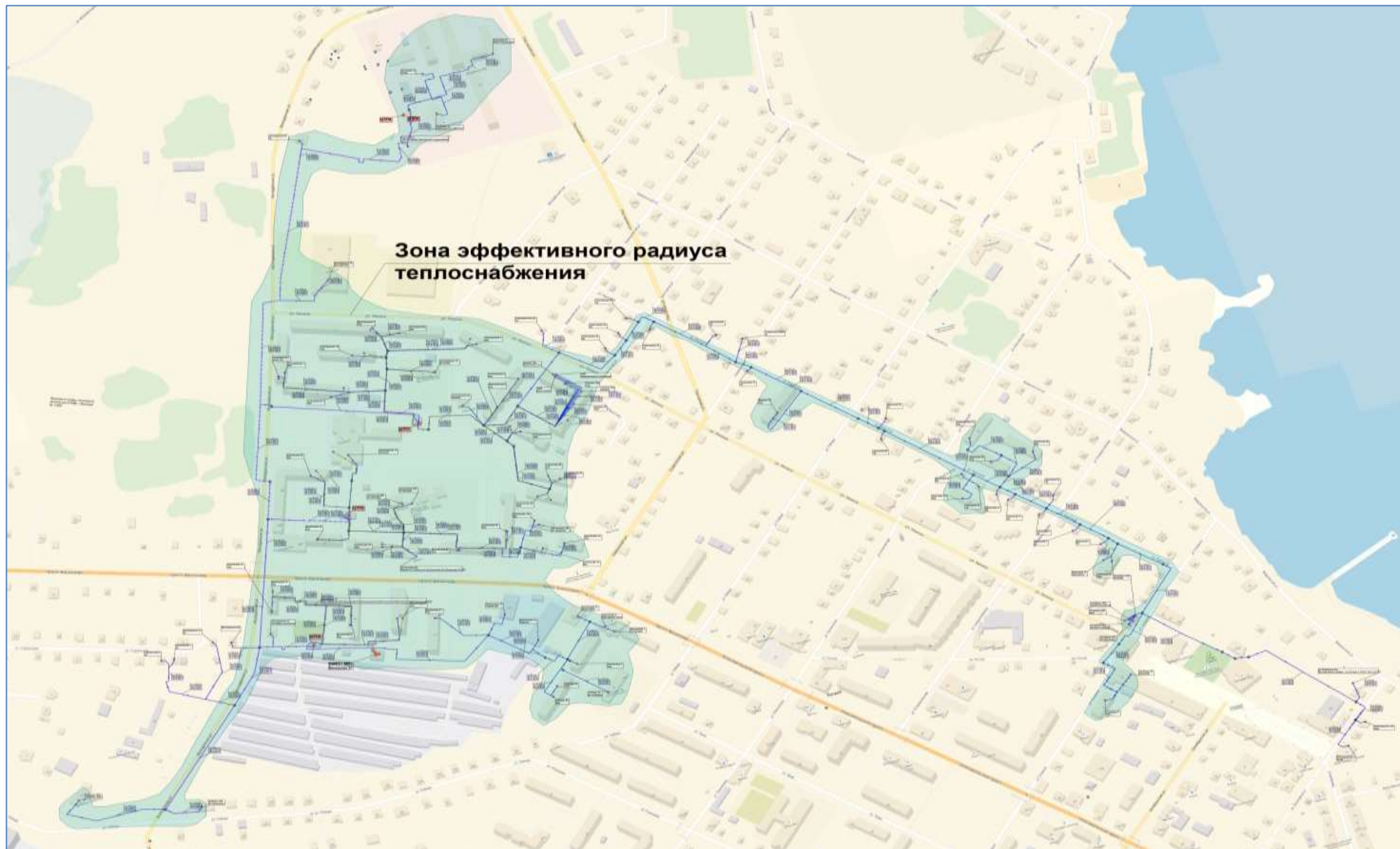
Рисунок 22. Зона эффективного радиуса теплоснабжения БМК 21 МВт
