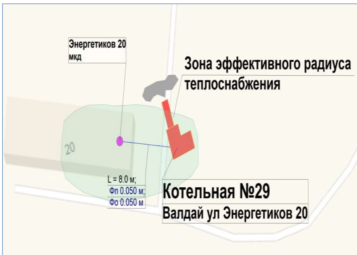
Рисунок 28. Зона эффективного радиуса теплоснабжения котельной № 29
