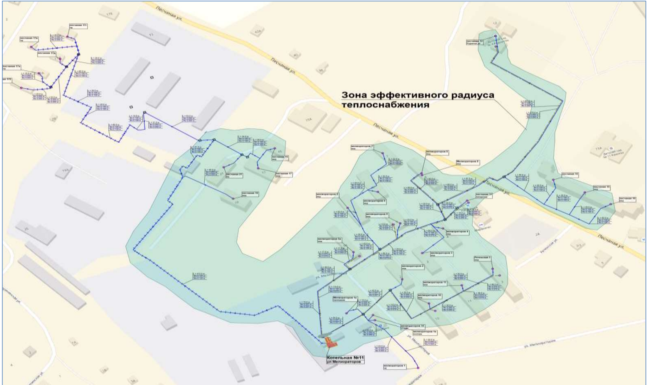
Рисунок 23. Зона эффективного радиуса теплоснабжения котельной № 11
