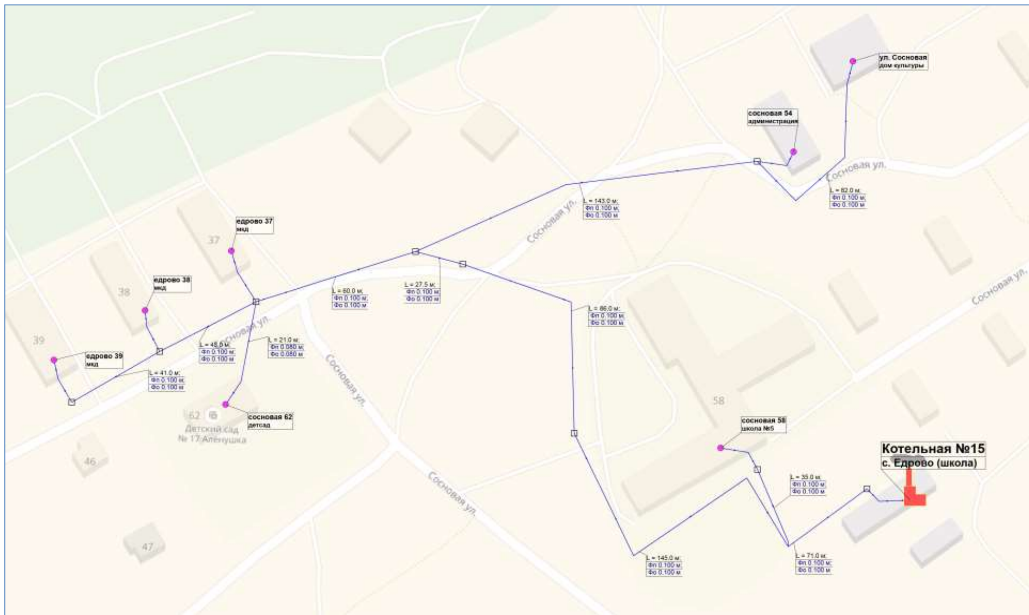
Рисунок 2. Схема тепловых сетей котельной № 15 с. Едрово (школа)
