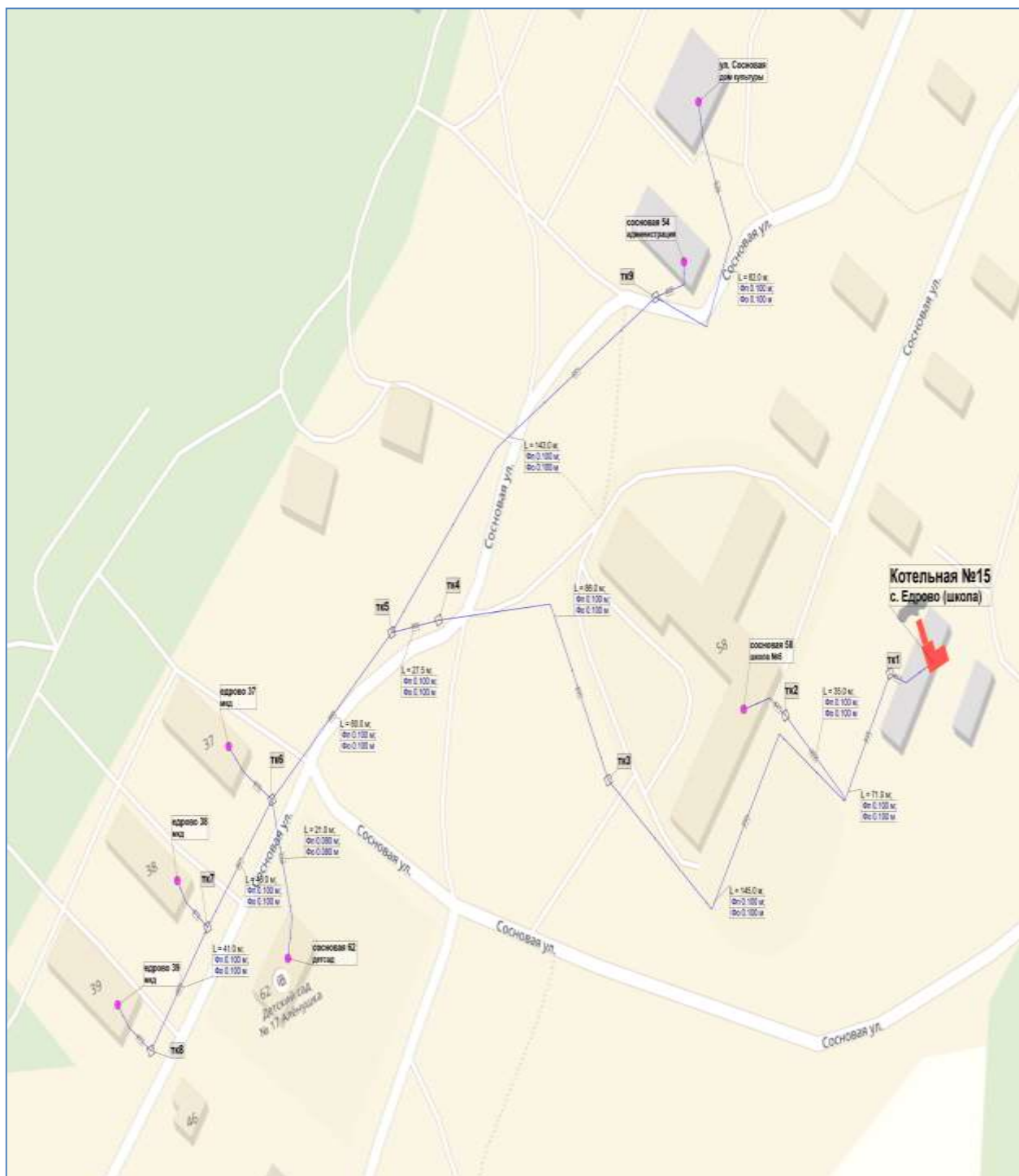
Рисунок 2. Схема тепловых сетей котельной № 15, с. Едрово
