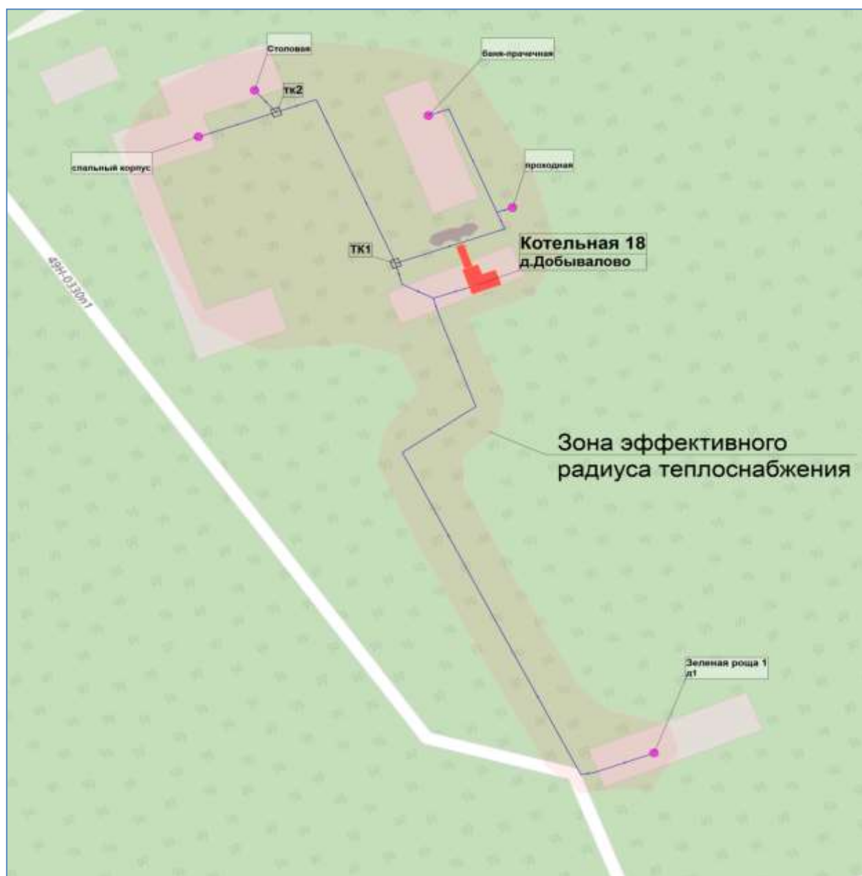
Рисунок 6. Зона эффективного радиуса теплоснабжения котельной № 18
