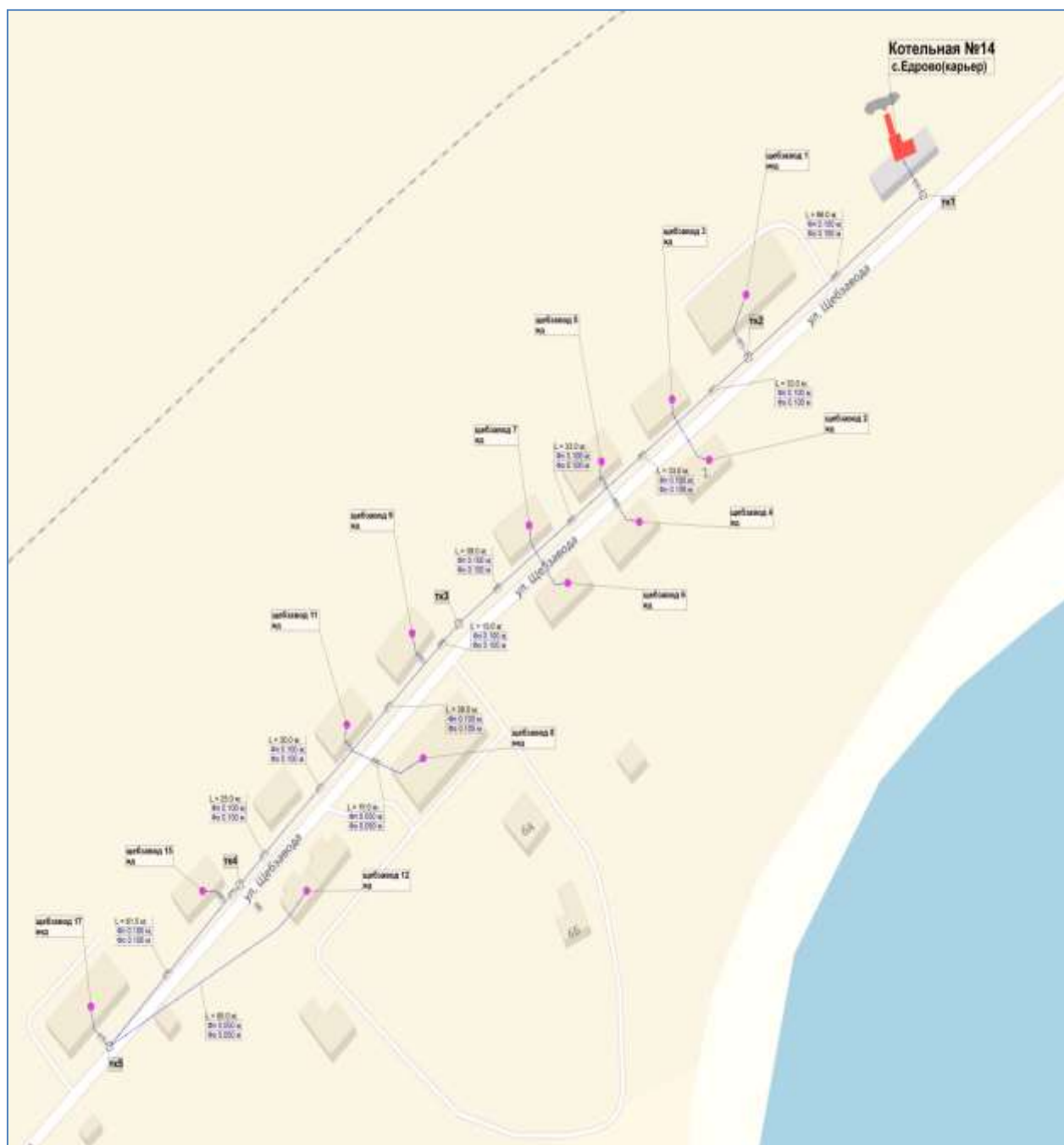
Рисунок 1. Схема тепловых сетей котельной № 14, с. Едрово
