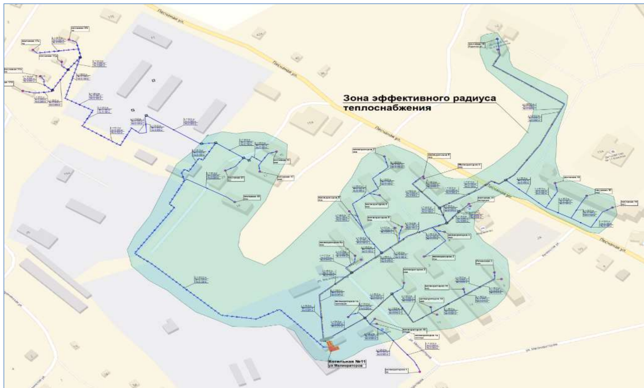
Рисунок 23. Зона эффективного радиуса теплоснабжения котельной № 11
