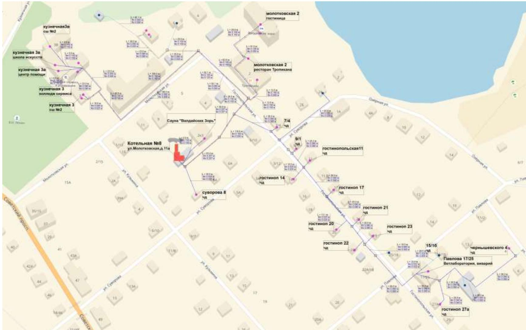
Рисунок 6. Схема тепловых сетей котельной № 8 г. Валдай, ул. Молотковская, д.11а
