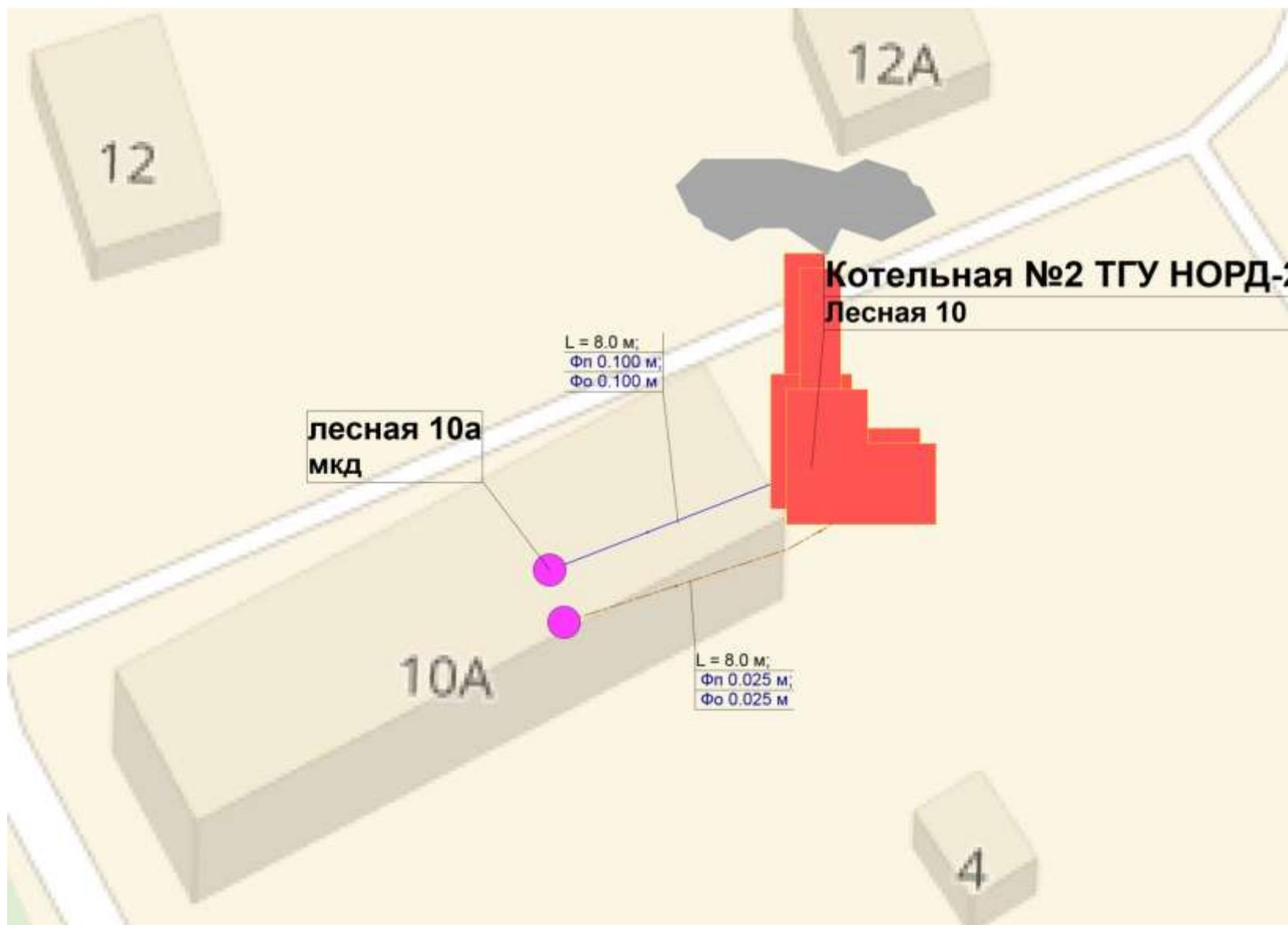
**Рисунок 2.** Схема тепловых сетей котельной №2 ТГУ г. Валдай, ул. Лесная, д. 6
