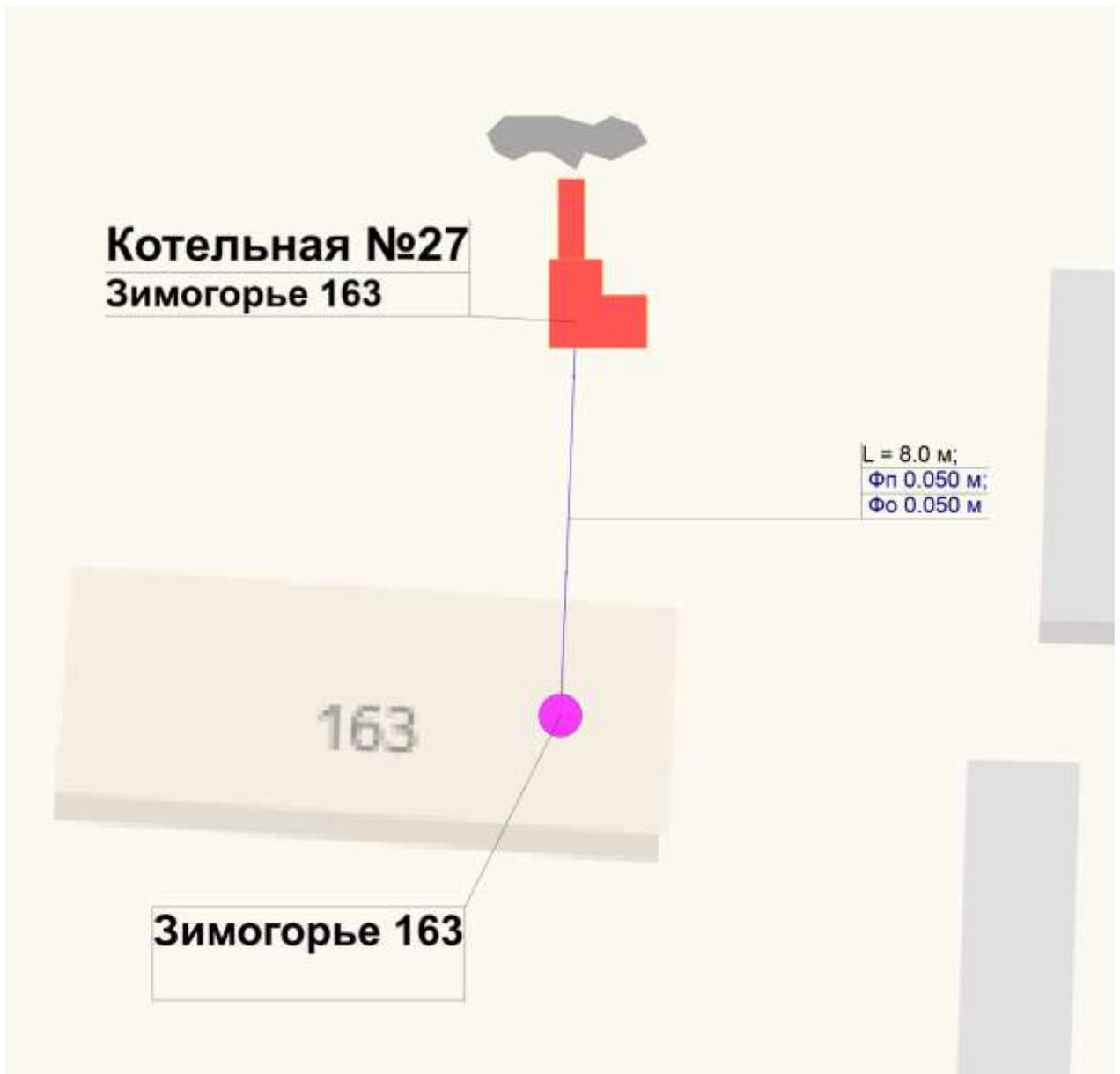
**Рисунок 11.** Схема тепловых сетей модульной котельной №27 с. Зимогорье, д. 163
